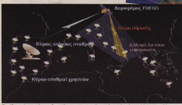
Παράδειγμα λειτουργίας του δορυφόρου, με την οπτική και τη θερμική ακτίνα, καθώς και τους δέκτες.
